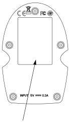
Место для этикетки с указанием номера прибора, серийного номера, информации о версии, соответствии стандартам и требованиях безопасности
